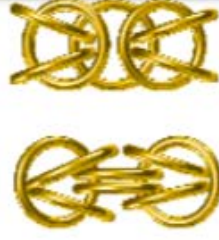
Şekil 2.9 : Diğer halkaların örülerek zincir baklalarının elde edilmesi
