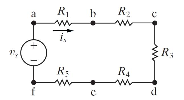
$$v_s = i_s R_1 + i_s R_2 + i_s R_3 + i_s R_4 + i_s R_5$$
