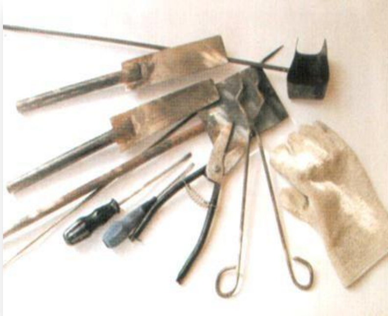
Cam şekillendirme çalışmalarında kullanılan çeşitli aletler.
