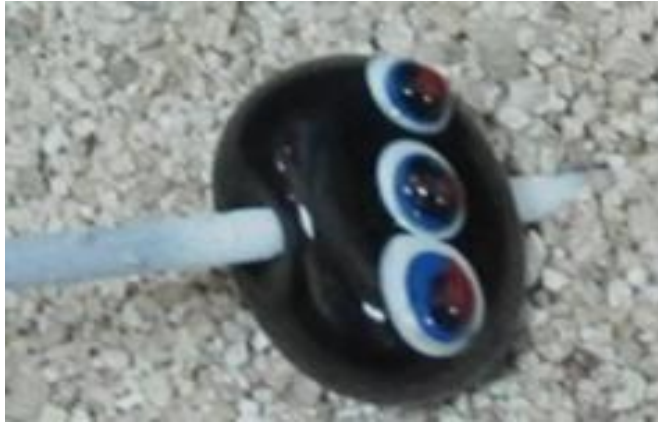
Soğutma kumu içerisine konulan cam boncuk
