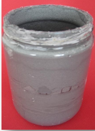
Kaolin bazlı mandrel sıvısı
