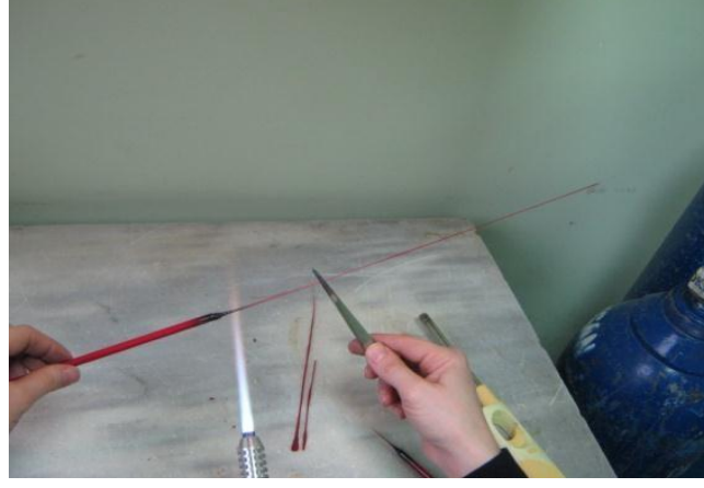
Şalümo ateşi ile çubuğun (stringer) kesilmesi
