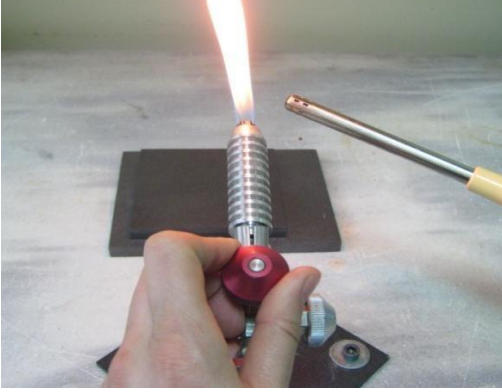
Şalümo'da gaz ayarının yapılması
