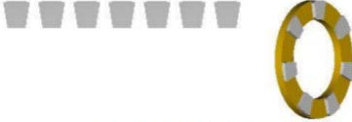
Şekil 2.1: Kontür parçalarının hazırlanarak kaynatılması
