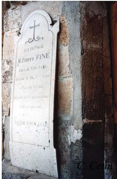
Resim 10. Villa-Vieille'de duvara monte edilmiş beyaz mermer plaka dışbükey deformasyona uğramış, Fransa, (Verges-Belmin, 2008, 13)
