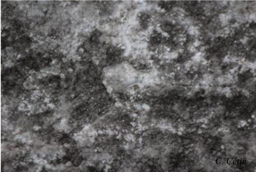
Resim 14. Theodosius Zafer Takı'na ait bir mermer mimari eleman üzerinde kimyasal bozulma nedeni ile şekerlenme görülüyor, İstanbul (C. Çetin)
