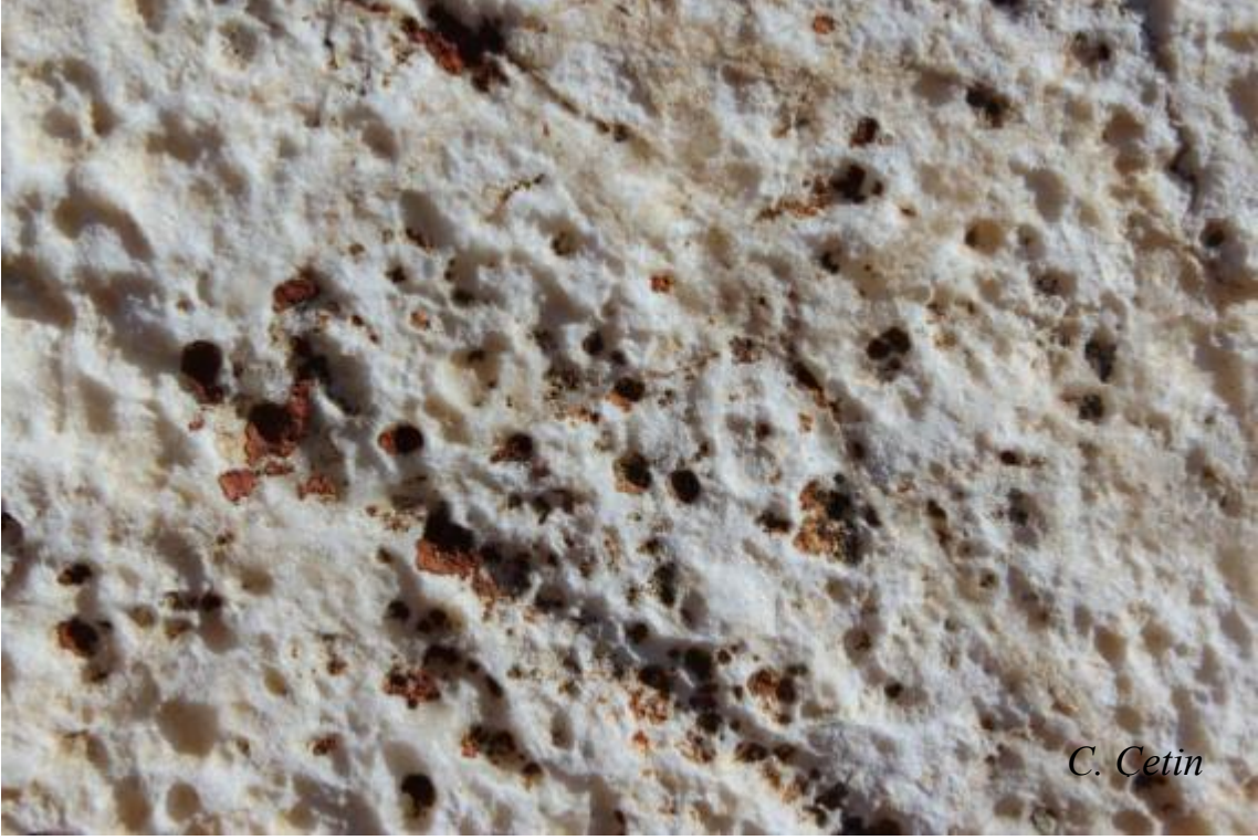
Resim 6. Mermerden yapılmış bir altar üzerinde mikro çukur oluşumu, Ankara, Nallıhan 2015 (C. Çetin)
