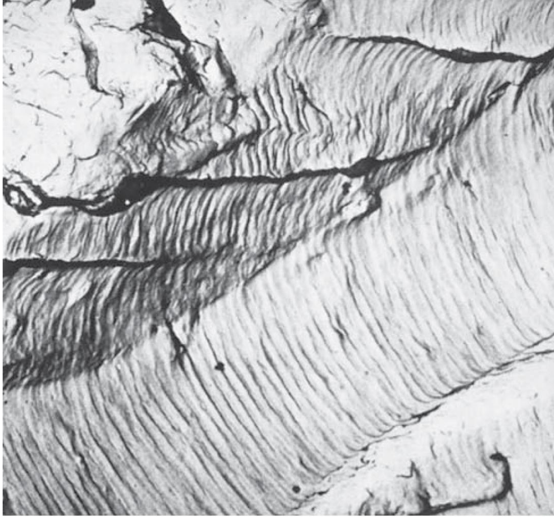
Şekil 8.22 Alüminyumda ince yorulma çizgilerini (striasyon) gösteren tarama elektron mikroskobu görüntüsü \times 9000 . (V. J. Colangelo and F. A. Heiser, Analysis of Metallurgical Failures , 2nd edition (1987). Yayın hakkı John Wiley & Sons Firmasına ait olup John Wiley & Sons Firmasının izni ile basılmıştır).
