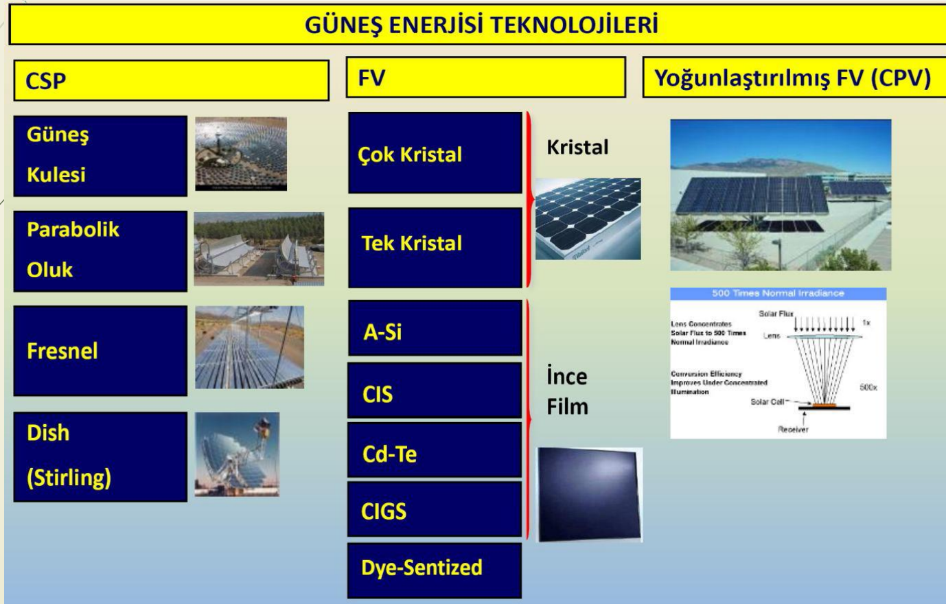
Şekil 4.9 Güneş enerjisinden elektrik üretimi için kullanılan sistemler ve sınıflandırılmaları (Anonim 2012b)
