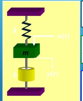
$$\begin{bmatrix} \dot{x}_1 \\ \dot{x}_2 \end{bmatrix} = \begin{bmatrix} 0 & 1 \\ -k/m & -b/m \end{bmatrix} \begin{bmatrix} x_1 \\ x_2 \end{bmatrix} + \begin{bmatrix} 0 \\ 1/m \end{bmatrix} u$$
