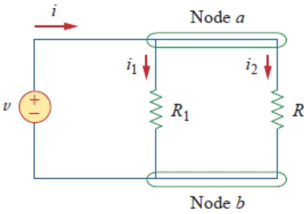
$$v = i_1 R_1 = i_2 R_2$$
