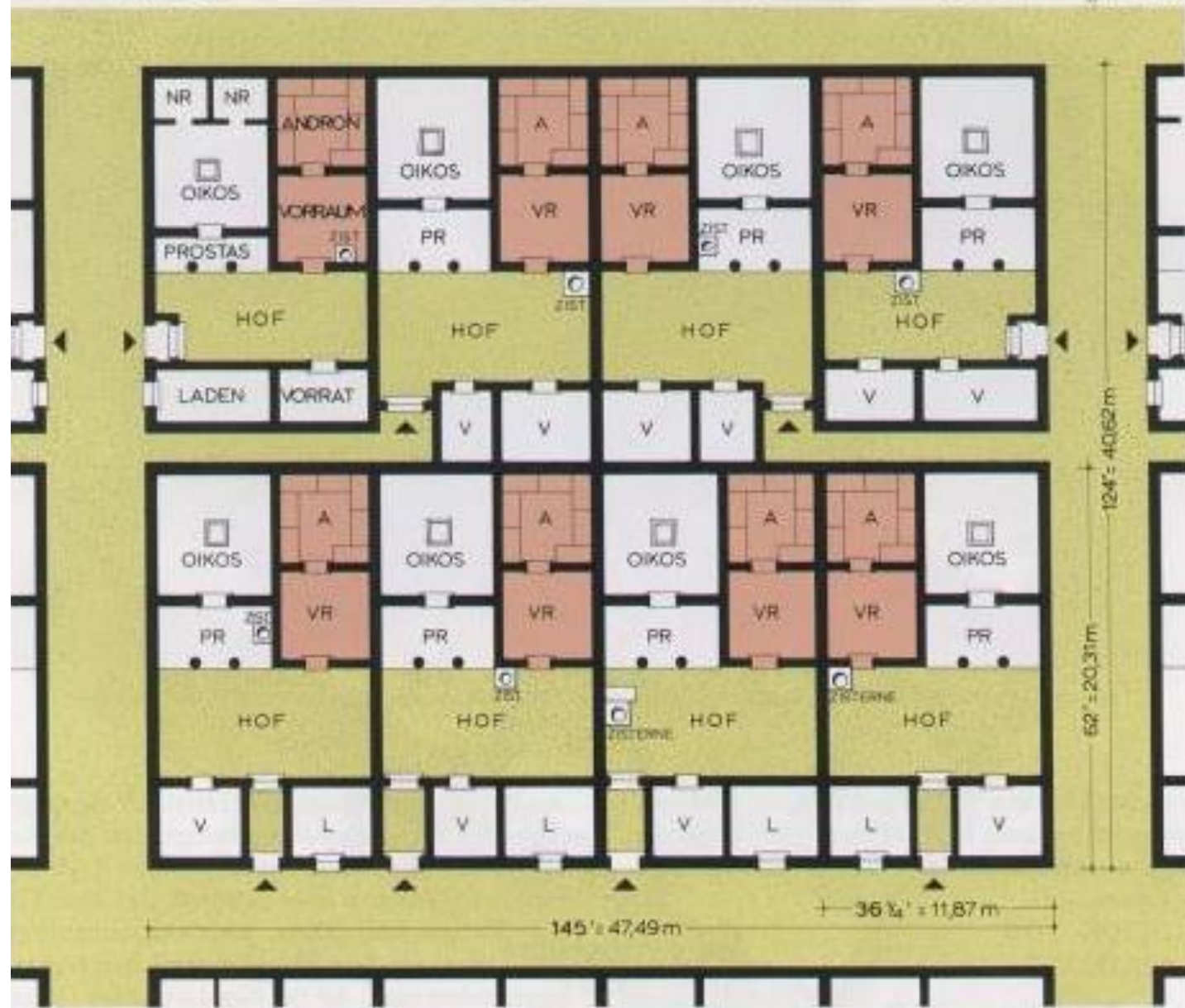
Abb. 31 Piräus. Rekonstruierte Insula mit acht Typenhäusern, vermutlich von Hippodamos entworfen. M. 1 : 400.
