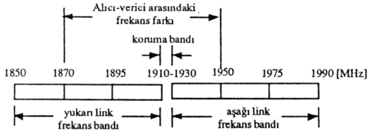
Şekil 4.9 Mobil telefon 1900 protokolünde frekans bandı.
