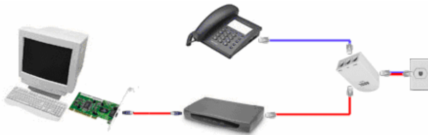
Şekil 3.2 Harici ADSL modemli bir bilgisayarın ADSL hatta bağlanması.
