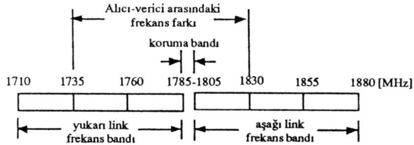
Şekil 4.8 Mobil telefon 1800 Protokolünde frekans bandı.
