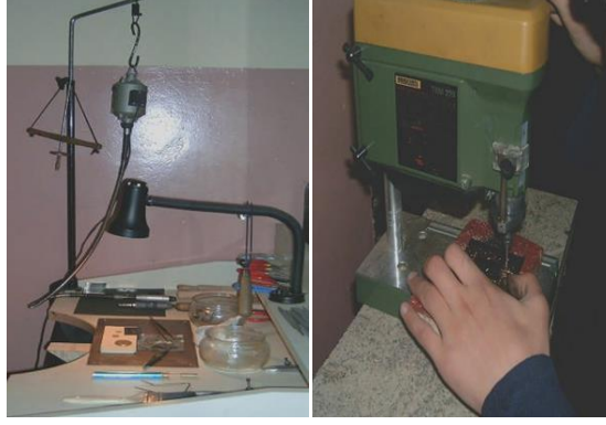
Freze motorunun çalışma konumu
