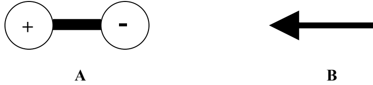
Şekil 1. A. Şematik bir dipol. Artı ve eksi yüklerin değeri birbirine eşittir. B. Aynı dipolün bir vektör olarak gösterimi. Vektörün uzunluğu potansiyel farkının büyüklüğüne bağlıdır ve vektörün ucu yüksek potansiyeli gösterir ( '+' ucu ).
