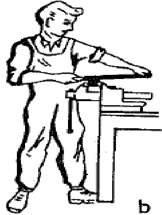
Şekil : 1-49 Eĝenin kollara uydurulmuş vücut hareketi ile sürülmesi : a) Doğru hareket. b) Yanlış hareket (iki ayak ta gergin).
