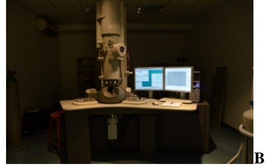
Şekil 6.8. A: Taramalı Elektron Mikroskobu (SEM: Scanning Electron Microscope), B: Geçirimli Elektron Mikroskobu (TEM: Transmission Electron Microscope) (Foto.: http://emb.ankara.edu.tr )
