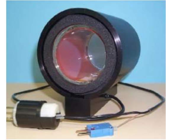
Yıldız ışığının içinden geçirilerek HF çizgilerinin yıldız tayfı üzerine "binmesiyle" 15 - 20 m/s hassasiyete ulaşılmasını sağlayan, tayfçekerin hemen önüne yerleştirilen HF gaz hücresi.
