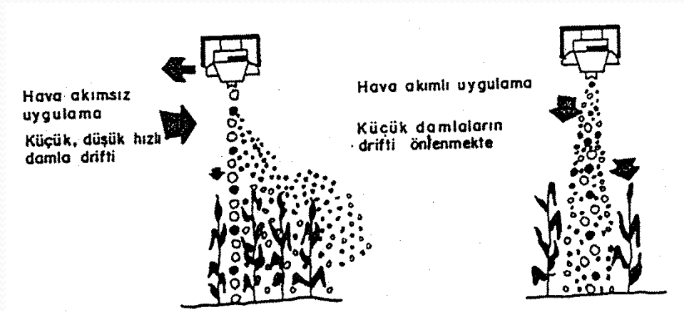
Şekil 4.112. Hava akımının damlayı hedefe yöneltme ve sürüklenmeyi azaltma etkisi
