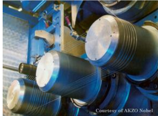
Resim 1.4: Rayon üretiminde germe-çekme
