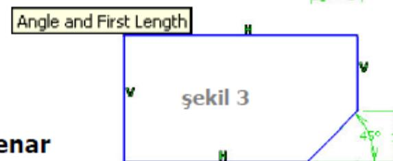
Pah işleminde ölçülendirmeleri üç farklı şekilde yapabiliriz. Açı ve hipotenüs(şekil 1), iki kenar uzunlukları ile(şekil 2), açı ve seçilen ilk kenarın uzunluğu(şekil 3) seçenekleri kullanılabilir.
