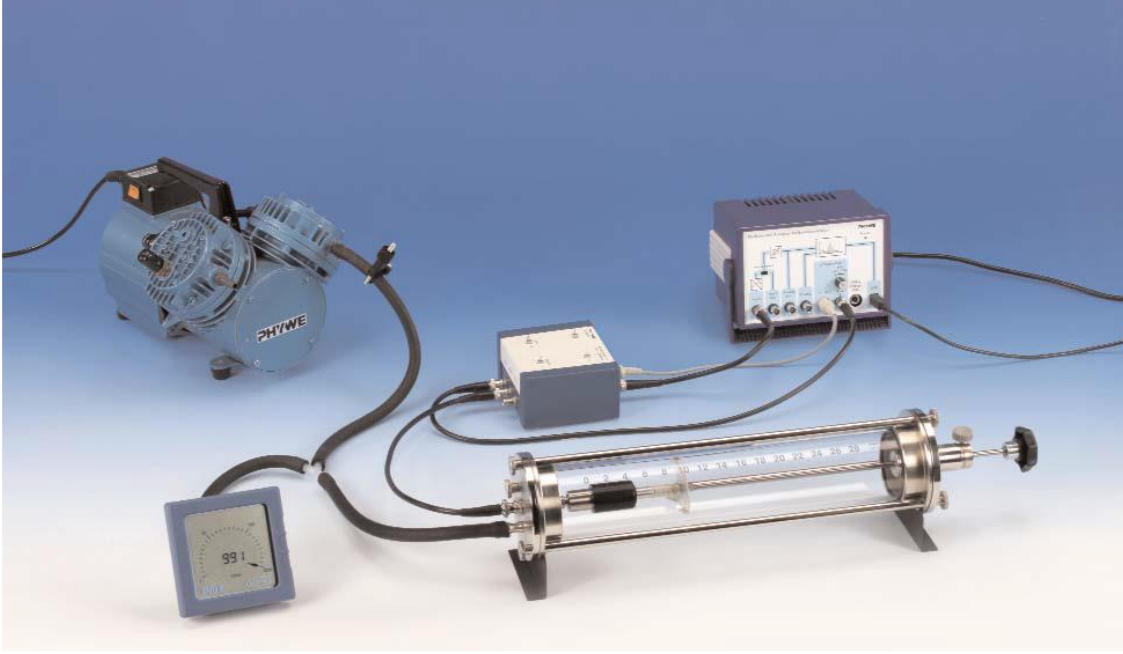
Şekil 1.2. 226 Ra kaynağının alfa enerjilerinin MCA yardımıyla incelenmesi deneyine ait deney düzeneği [3]
