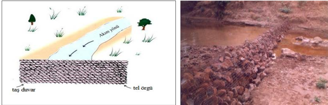
Şekil 4.23 Tel örgü ile güçlendirilmiş taş duvar (Anonymous 2016e)
