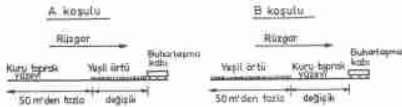
Şekil 4.3. Buharlaşma kabının yerleştirildiği çevre koşulları.
