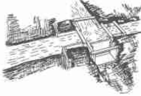
Ahsap su ayırma yapısı
