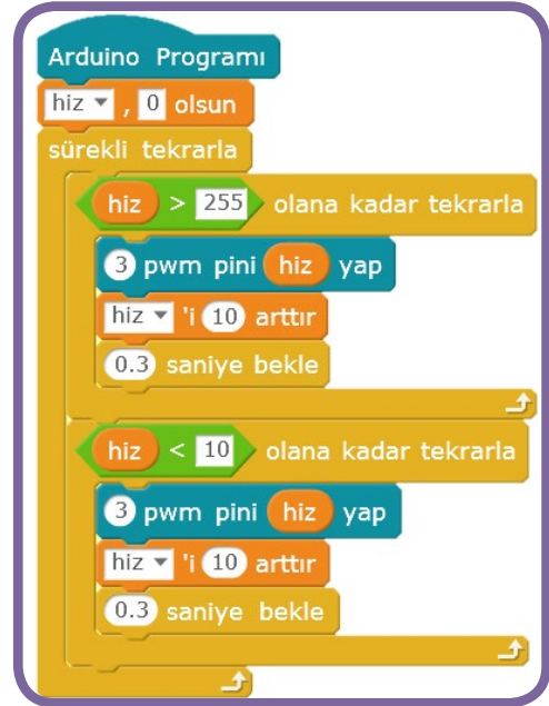
Şekil 148: Motor hız kontrol devresi kodları
