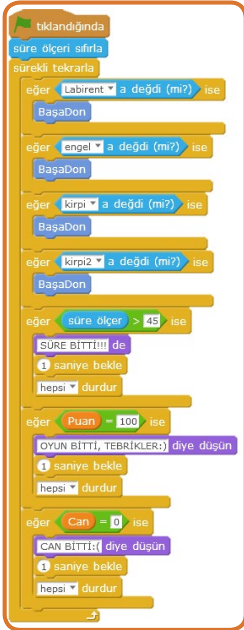
Şekil 95: Pacman kuklasının diğer kuklalara çarpması durumunda süreölçer, puan can değişkenlerinin değerini sorgulayan komutları
