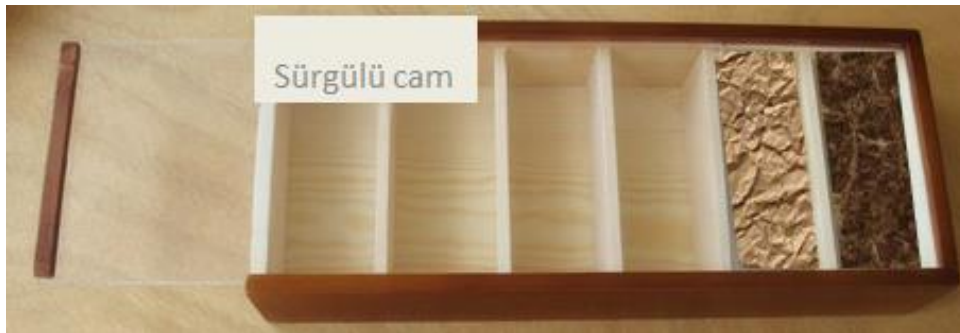
Şekil 1.5. Bir toprak serisine ait horizonlardan alınmış temsili toprak örneklerinin serinin morfolojik özelliklerinin hatırlanması amacıyla kullanılabilecek ahşap kutu örneği
