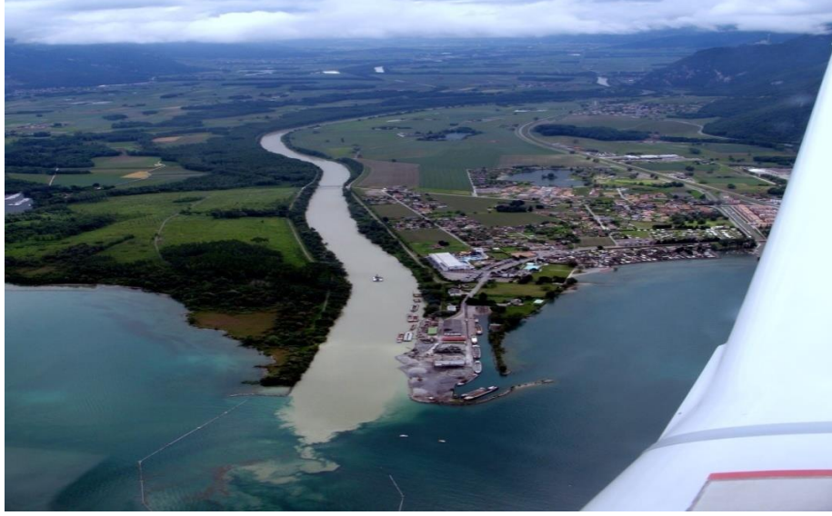
Şekil 2.45. Delta oluşumu (Arka planda aluviyal taşkın ova arazileri ve en önde deniz içerisinde karasal aluviyal malzemelerin-akarsu yüklerinin depolanması olayı)
