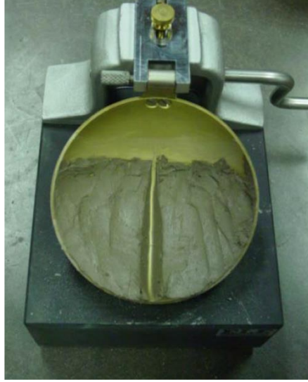
Şekil 4.3.20. Plastik likit limit analizinde kullanılan Casagrande aygıtı
