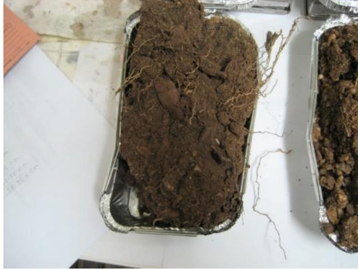
Şekil 4.3.23. Toprakta bozulmadan alınan örneğin ince kesit olarak hazırlanma aşaması
