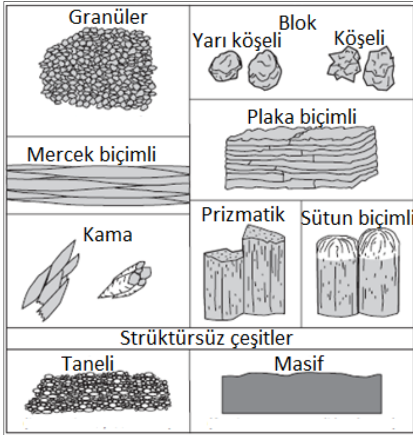
Şekil 4.1.7. Profil içinde tanımlanabilecek toprak strüktür tipleri
