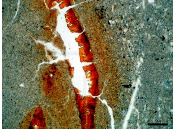
Şekil 4.3.14. Taban suyu etkisinde jarosit minerali gelişimi
