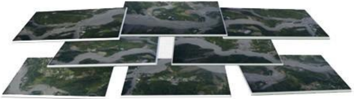
Şekil 5.89. Mozaikleme öncesi alana ait görüntülerin birbirleri ile bindirmeli olarak birleştirilmiş şekli ( www.somenge.com.br )
