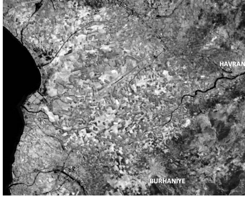
Şekil 5.103. Radarsat-1 ve Landsat uydu görüntüsü 3. Band birleştirilerek (fusion) elde edilen zenginleştirilmiş görüntüsü (Kurucu ve Balık, 2003)
