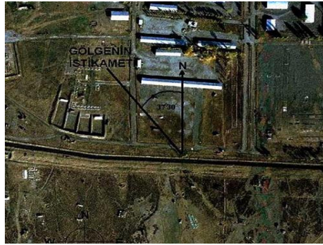
Şekil 5.40. Hava fotoğrafının gölge yöntemiyle yönüne konulması (Durgut, 2005)
