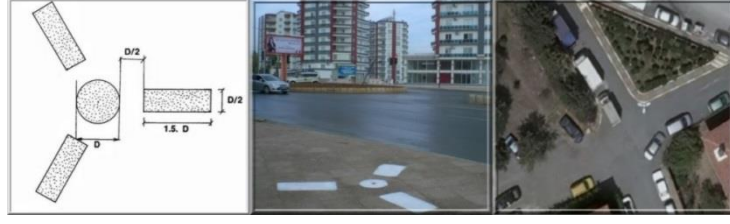
Şekil 5.88 Hava fotoğraflarının ortorektifikasyonları için gerek duyulan ve koordinatları bilinen yer kontrol noktalarının tesisi edilmesi (Anonim 2014).
