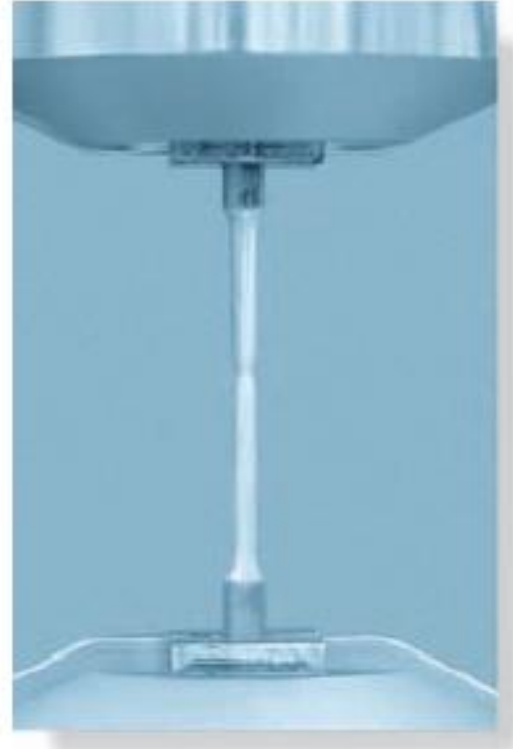
Çekme altında metal malzemede boyun oluşumu ve yenilme
