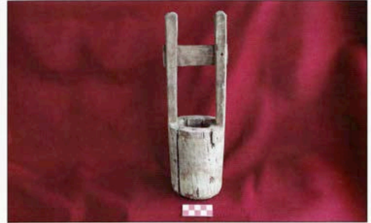
Şekil 33- Madenci Kovası: 19. yy'a ait olup, Anayatak-Madeni'de (Elazığ) bulunmuştur. Kova boyu 31,5 cm ve kova çapı 10,5 cm'dir. MTA müzesinde 632 envanter numarası ve 31 teşhir numarası ile sergilenmektedir.
