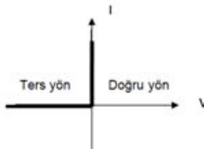
Şekil 3.2 İdeal bir diyot için akım-gerilim grafiği
