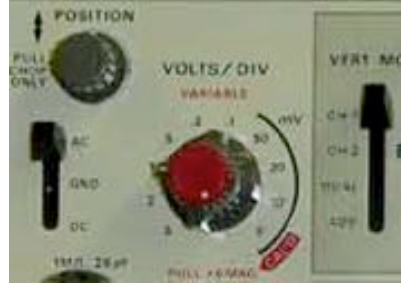
Şekil 7.6 Osiloskop üzerindeki gerilim skalası
