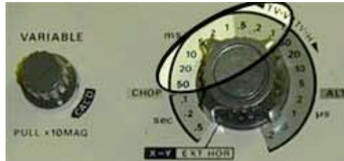
Şekil 7.5 Osiloskop üzerindeki frekans skalası
