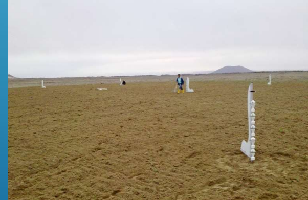
Meteoroloji istasyonu ve BEST sediment ucuların araziye yerleştirilmesi, Konya Karapınar, 2010
