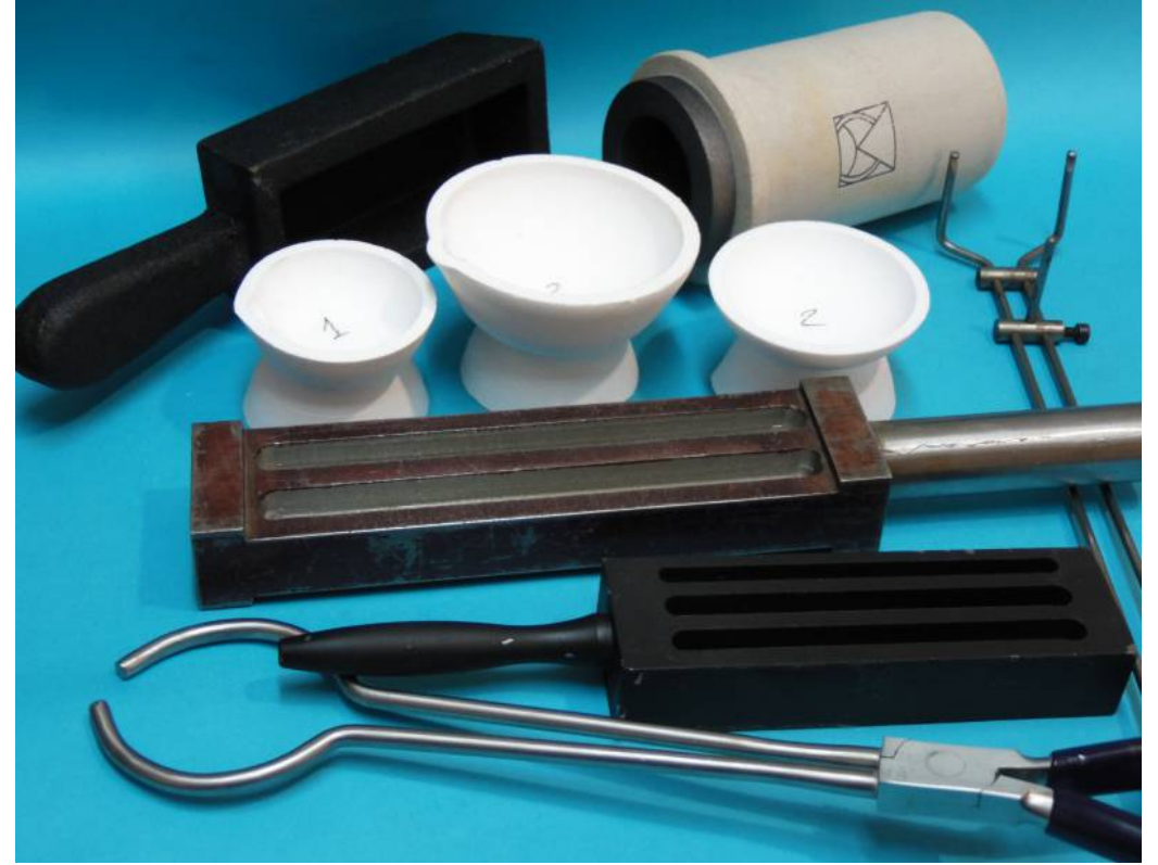
Fotograf 1.Gümüş alaşım ve gümüş kaynak yaparken kullanılan malzemeler (Has gümüş,Bakır,Şalümo,Tel ve Astar Şideleri,Pota,Boraks,Maşa)
