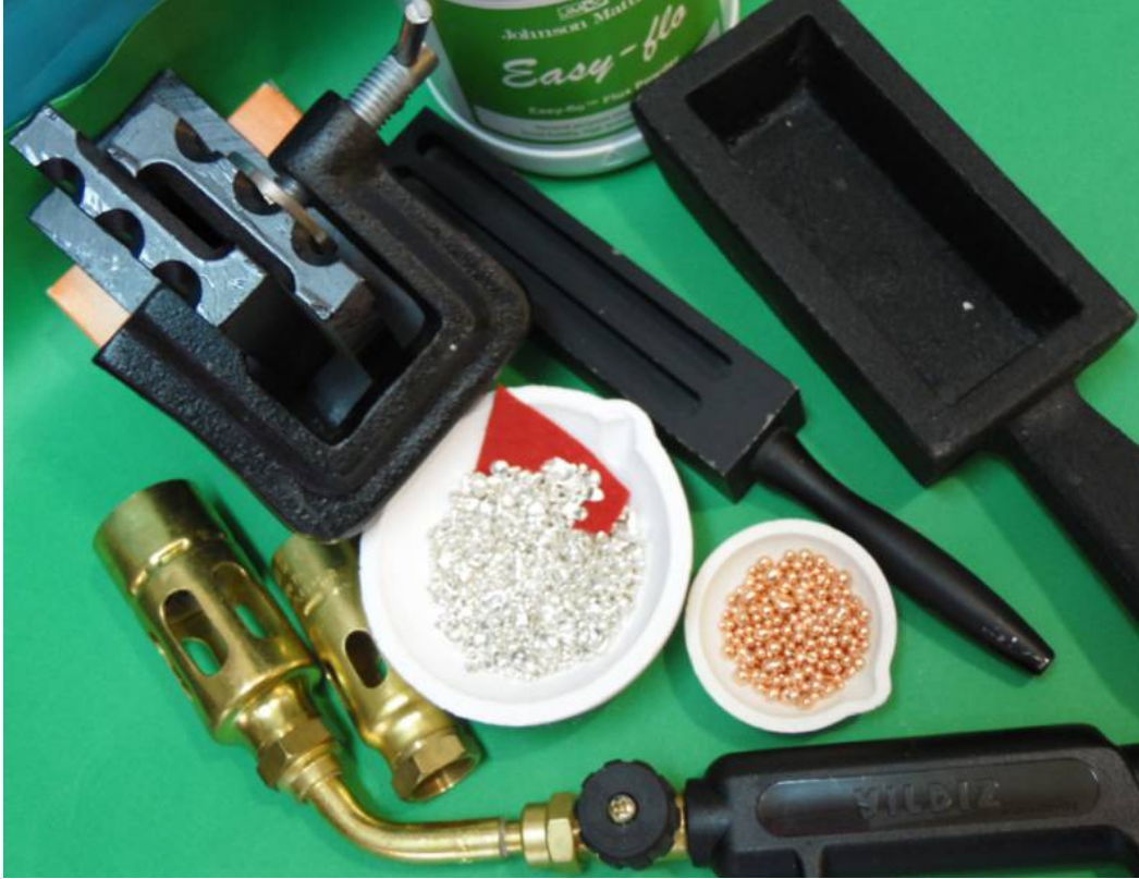
Fotograf 1.Gümüş alaşım ve gümüş kaynak yaparken kullanılan malzemeler (Has gümüş,Bakır,Şalümo,Tel ve Astar Şideleri,Pota,Boraks,Maşa)
