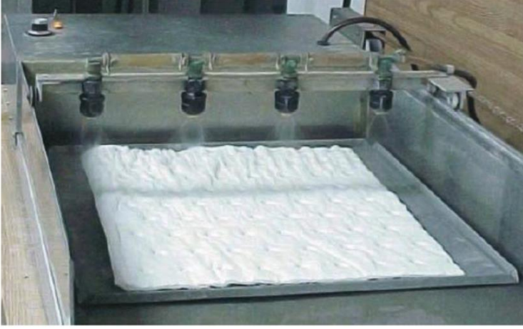
Şekil 10: Optimum ve homojen sulama yaparak testten daha doğru sonuçlar alınmasını sağlayan otomatik bir sulama sistemi
