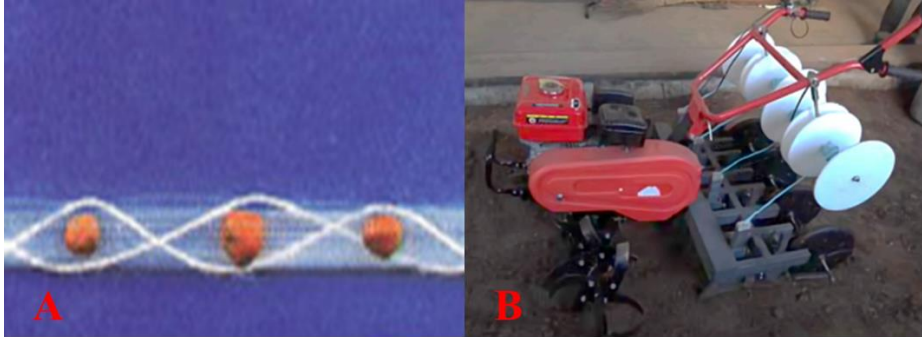
Şekil 6: Bantlanmış tohum (A) ve bantlanmış tohum ekim makinesi (B). (Anonim, 2024d)
