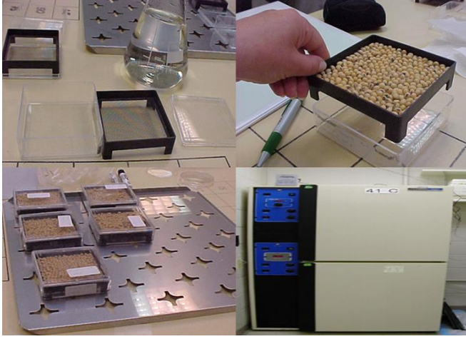
Şekil 5: Hızlandırılmış yaşlanma testinde kullanılan ekipmanlar ve testin uygulanışı
