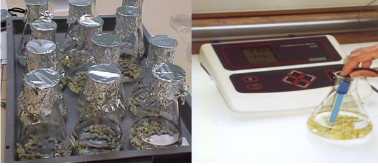
Şekil 3: EC testinin bezelye tohumlarında uygulanışı
