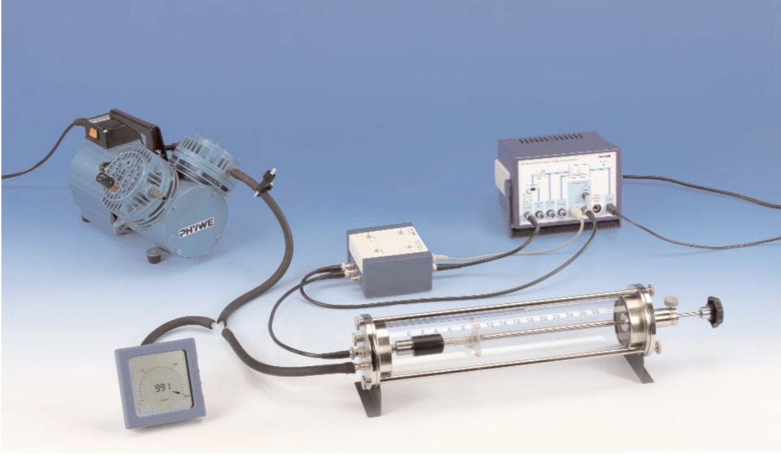
Şekil 1.2. ^{226}\text{Ra} kaynağının alfa enerjilerinin MCA yardımıyla incelenmesi deneyine ait deney düzeneği [3]
