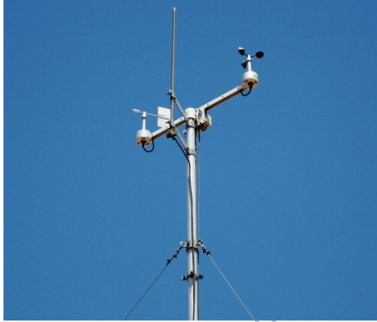
Şekil X: Bir otomatik hava gözlem istasyonundaki bir anemografin rüzgar hızını ve yönünü ölçerek veri toplama bölümüne elektronik olarak gönderen rüzgar hız ve yön algılayıcısı (Foto: Murat Türkeş, 6 Haziran 2013, MGM Ulukışla OHGİ parkı).
