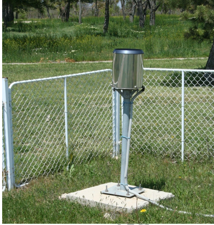
Şekil X: Bir konvansiyonel klimatoloji/meteoroloji ya da otomatik hava gözlem istasyonunda yağış gözlemi yapılmasında kullanılan bir plüviografin (yazıcısı olan yağışölçer) görünüşü (Foto: Murat Türkeş, 26 Nisan 2013, GTHB Bahri Dağdaş Uluslararası Tarımsal Araştırma Enstitüsü OHGİ parkı).
