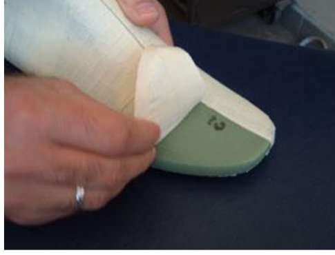
Bandın kalıptan sökülmesi
