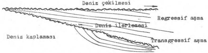
Şekil 57. Regressif ve Transgressif aşma ile kaplama arasındaki ilişkileri gösteren kesit
