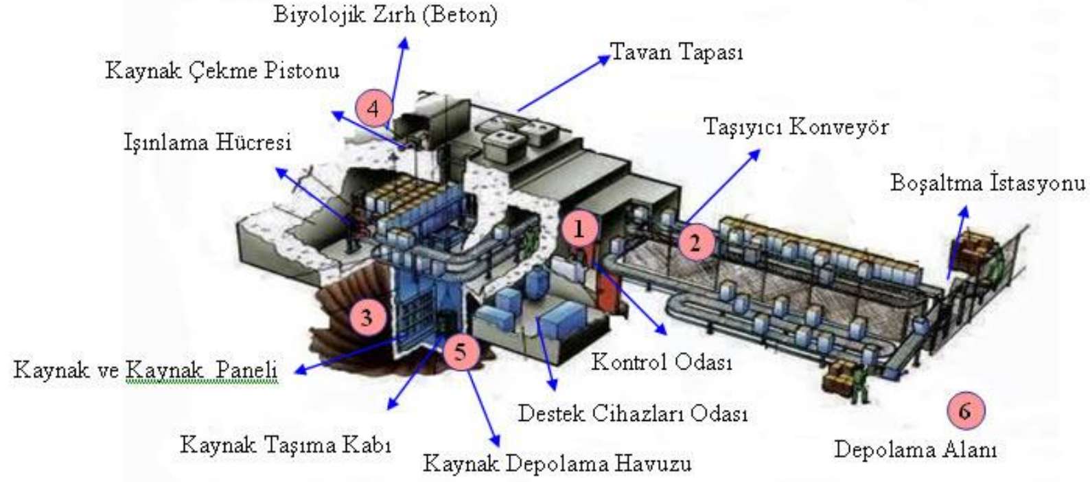
Şekil-1: Kutu Taşıyıcı Co-60 Işınlama Cihazı
