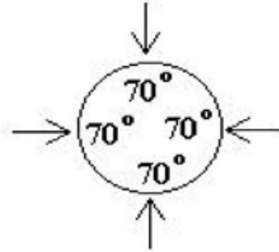
k deęeri ok yksek olmalıdır ki sıcaklık hemen merkeze gesin ve  $T_{\text{merkez}} = T_{\text{yzey}}$
