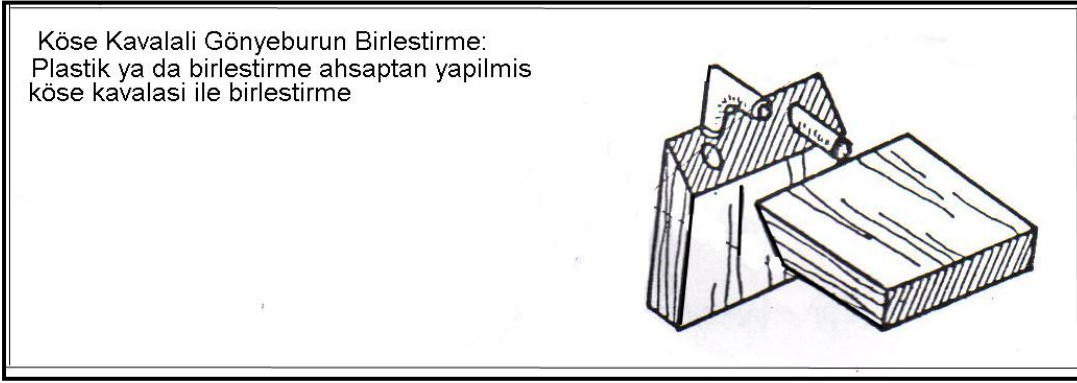
Şekil 20: Ahşap köşe bağlantısı; Köşe kavalalı gönyeburun birleştirme.
