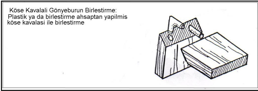
Şekil 18: Ahşap köşe bağlantısı. Köşe kavalalı gönyeburun birleştirme.
