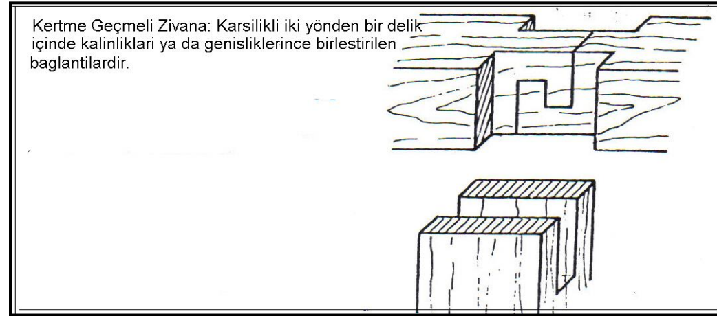
Şekil 21: Ahşap bağlantısı; Kertme geçmeli zivana.
