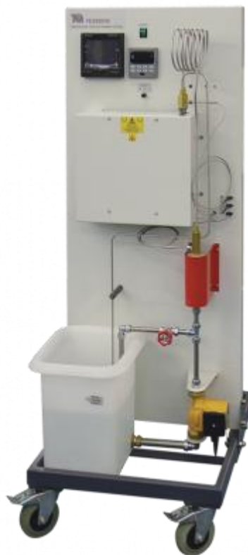
Sıcaklık Kontrol Sistemi
