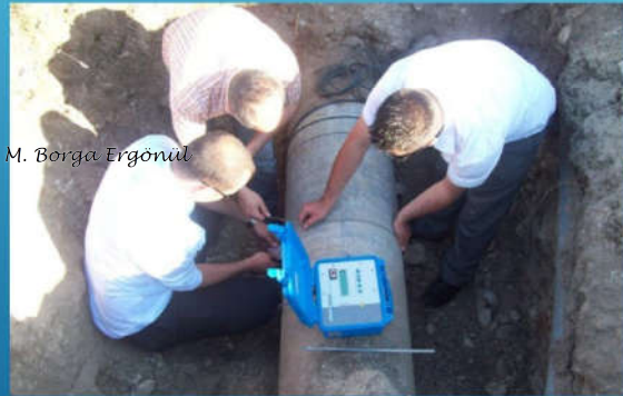
Kapalı borularda ultrasonik yöntemle debi ölçümü
