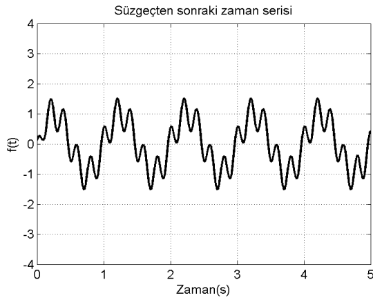
Şekil 4. 24 Zaman serisinin süzgeç katsayıları ile evrişimi ile süzgeçleme
