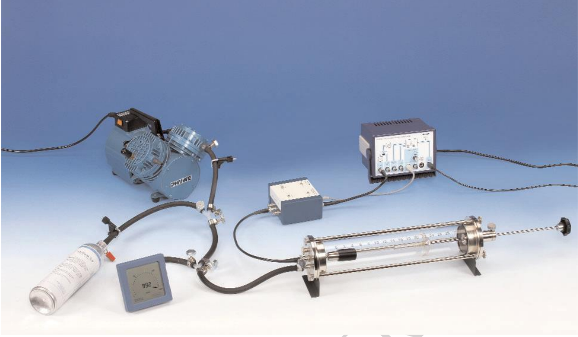
Şekil 2.4. Gazlarda \alpha -parçacıklarının enerji kaybının MCA yardımıyla incelenmesi deneyine ait deney düzeneği [5]
