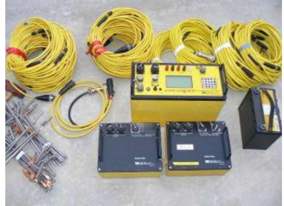
Çok elektrotlu/kanallı öz direnç ölçüm sistemleri (AGI, Super Sting R8)
