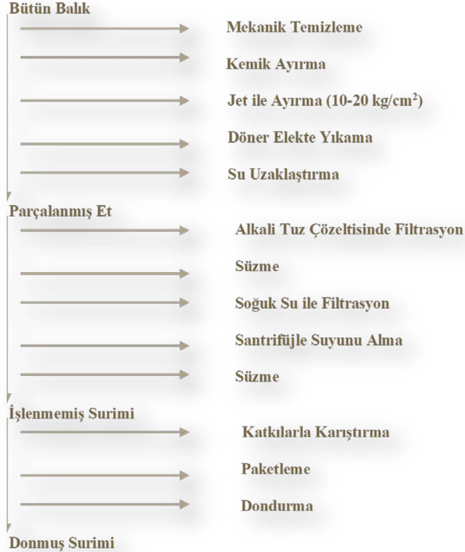
Şekil 5. Kırmızı etli (yağlı) balıklardan Jet metodu ile surimi üretimi
